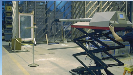
Das fixierte ‚Schwalbenfenster‘ wurde mit 240cm langen Dachlatten aus einer Druckluftkanone beschossen
