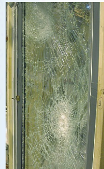
Trotz einer Auftreffgeschwindigkeit von rund 60 km/h wurden weder die Folie im Verbundglas durchbrochen noch die Gehrungsecken beschädigt
